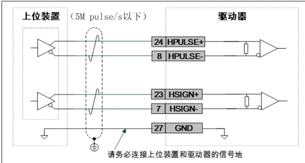
注意：必须保证差分输出为 5V 系统；必须将上位装置的 GND 连接到驱动器的信号地。
