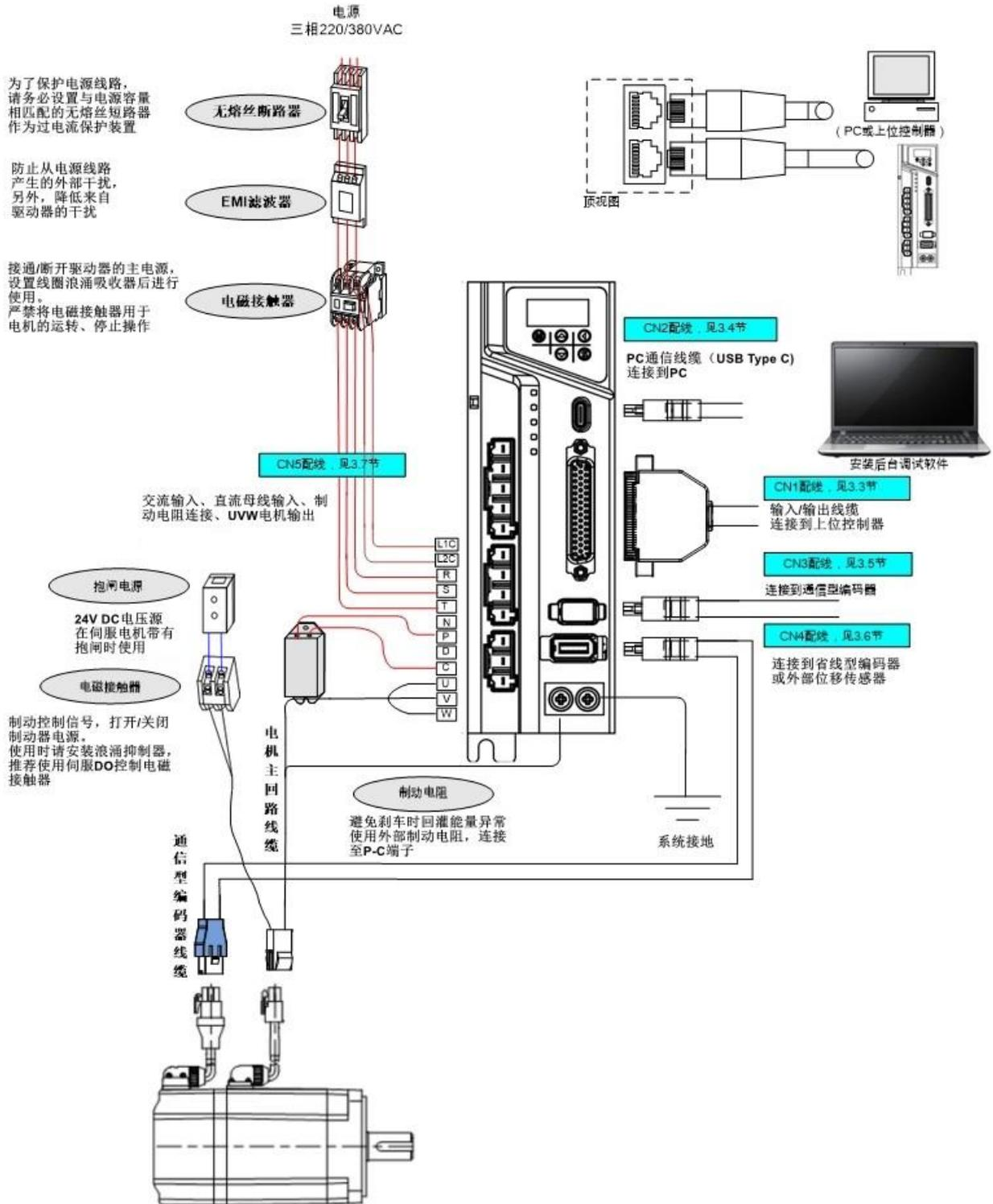
备注：上图中的驱动器以 SIZE-C/SIZE-D 举例说明，SIZE-E 的端子连线方法与 SIZE-C/SIZE-D 相同，但端子的外观及位置有所差异。
