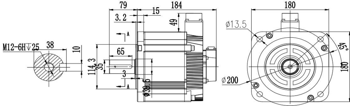
◆ EAM-WG-2915T-U32 2.9kW 带抱闸伺服电机安装尺寸图 (单位为 mm)
