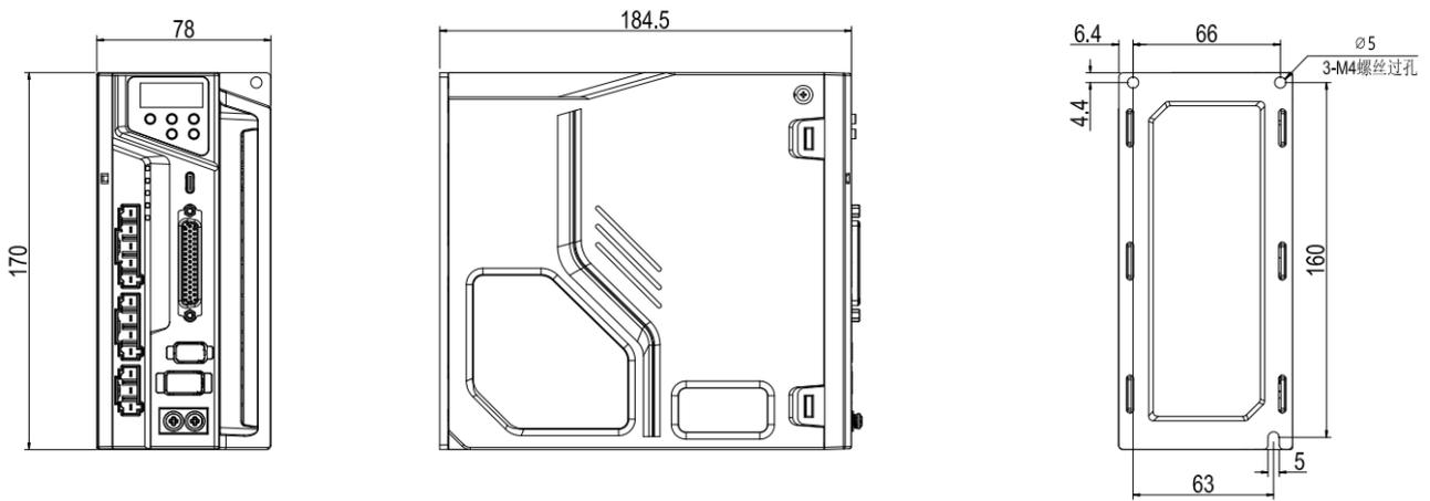
◆ SIZE-E 安装尺寸图 (单位 mm) :
