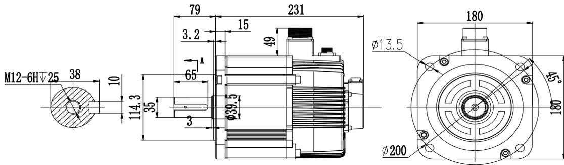
◆ EAM-WG-4315T-U30 4.3kW 不带抱闸伺服电机安装尺寸图 (单位为 mm)
