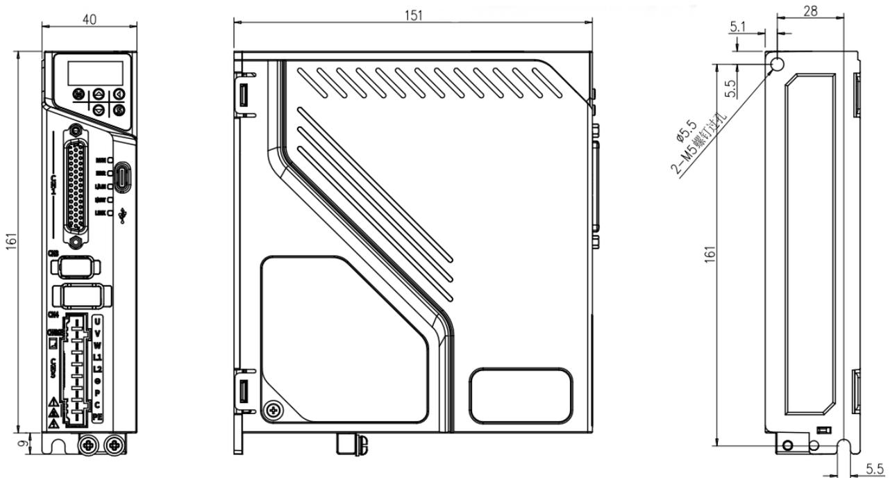
◆ SIZE-B 安装尺寸图 (单位 mm) :
