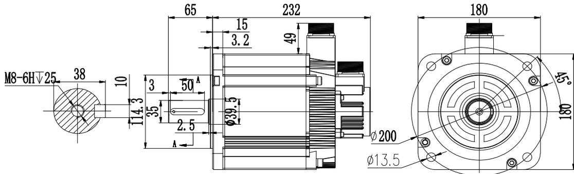
◆ EAM-WG-4315T-U32 4.3kW 带抱闸伺服电机安装尺寸图 (单位为 mm)
