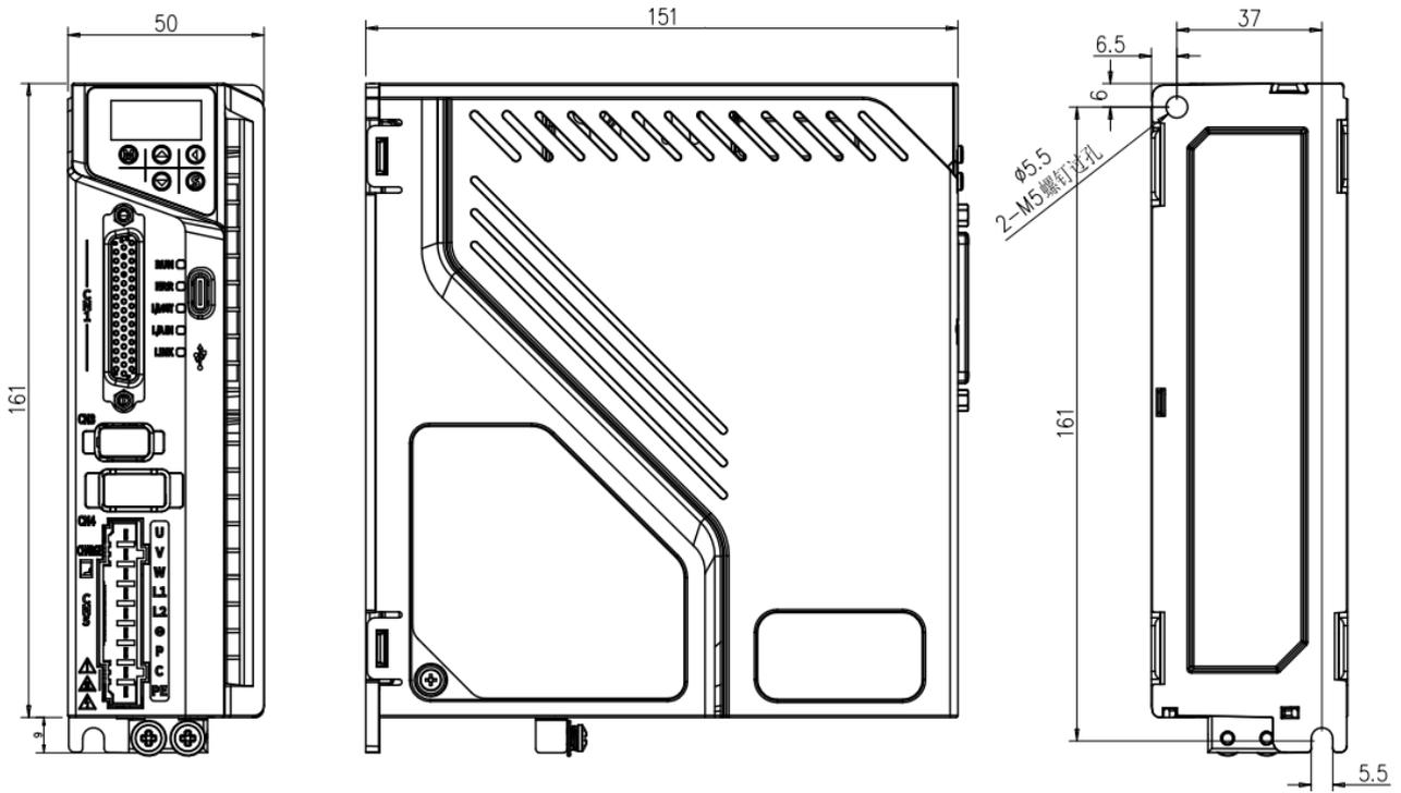
◆ SIZE-C 安装尺寸图 (单位 mm) :
