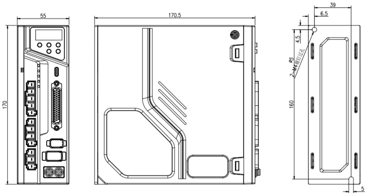
◆ SIZE-D 安装尺寸图 (单位 mm) :
