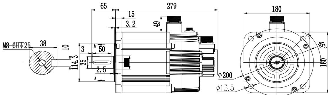
◆ EAM-WH-7515T-U30 7.5kW 带抱闸伺服电机安装尺寸图（单位为 mm）
